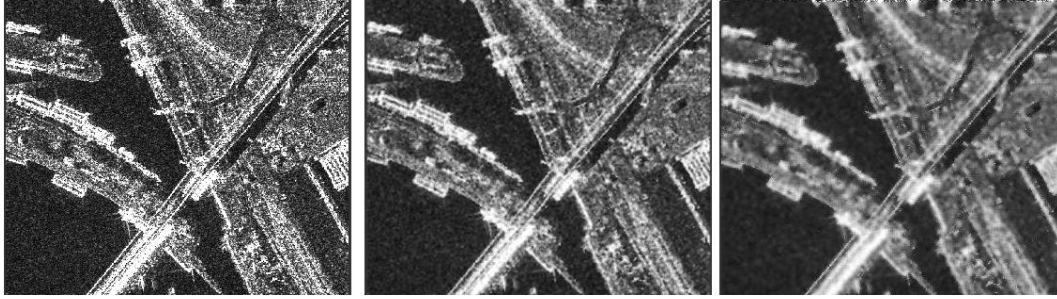
Obr. 5 Vľavo: výrez amplitúdových dát Bratislavy (misia TSX, 11. nov. 2008), pôvodný zašumený obrázok. V strede: aplikácia základného Leeho filtra s oknom pre odhadovanie štatistických veličín 5 \times 5 . Vpravo: aplikácia základného Leeho filtra s oknom pre odhadovanie štatistických veličín 9 \times 9 .
