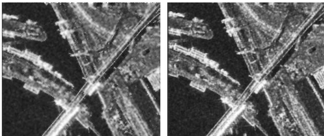
Obr. 6 Vľavo: výrez amplitúdových dát Bratislavy (misia TSX, 11. nov. 2008), aplikácia Leeho filtra s oknom 9 x 9. Vpravo: aplikácia 5 krokov filtra SRAD na pôvodný obrázok (veľkosť časového kroku 0,2) s automaticky prepočítavaným koeficientom variácie pre šum. Počiatočná hodnota \sigma_v^2 = 0,5227^2 .
