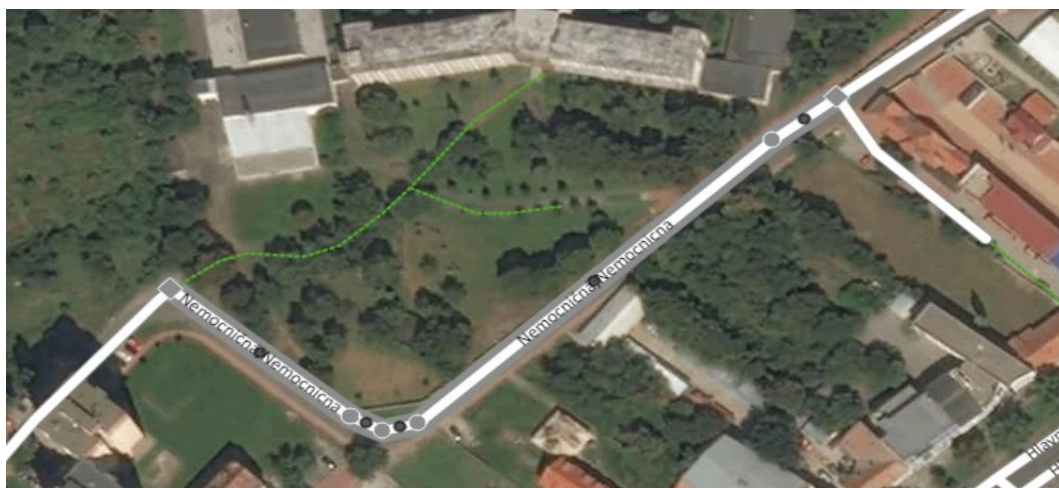
Obr. 1 Ukážka časti cesty s uzlovými, lomovými a virtuálnymi bodmi v softvérovom prostredí Map Creator
