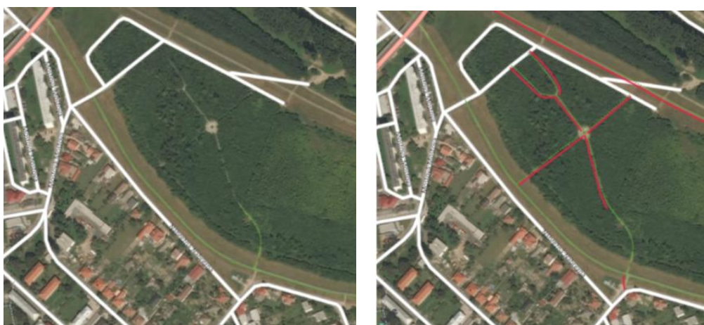
Obr. 8 Ukážka časti siete pozemných komunikácií v nezastavanom území mesta Šaľa pred aktualizáciou (obrázok vľavo) a po aktualizácii (obrázok vpravo)
