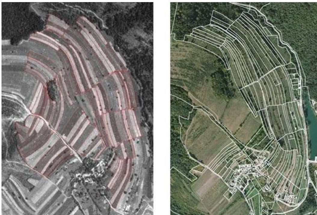
Obr. 4 Identifikácia parciel na historickej ortofotomape KÚ Mikšová časť Beňov (vľavo), porovnanie stavu s aktuálnou ortofotomapou a zobrazením parciel registra C KN (vpravo).
