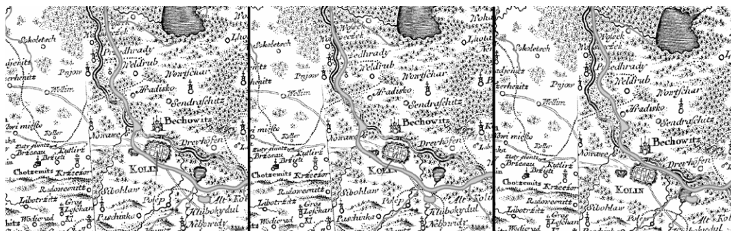
Obr. 6 Srovnání deformace detailu mapy pro afinní, polynomičkou 3. řádu a spline transformaci
