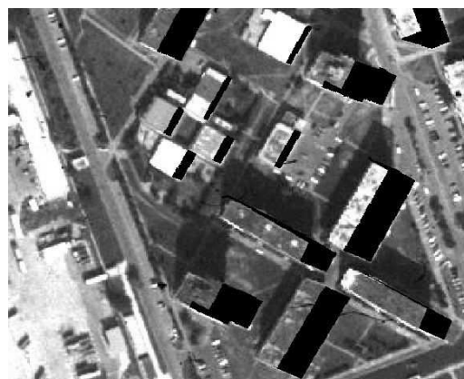
Obr. 5 Ortofotosnímkka bez perspektívneho skreslenia výškových objektov a po odstránení duplicitných prvkov obrazu
