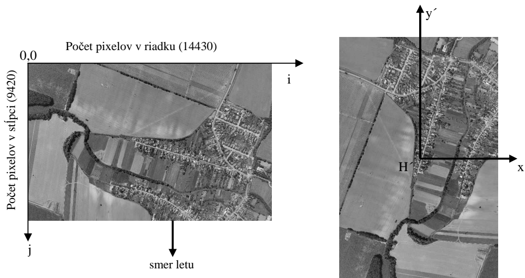
Obr. 1 Uloženie dát na disku (vľavo) a vnútorná orientácia digitálneho obrazu (vpravo) (C) PHOTOMAP, s.r.o., www.photomap.sk
