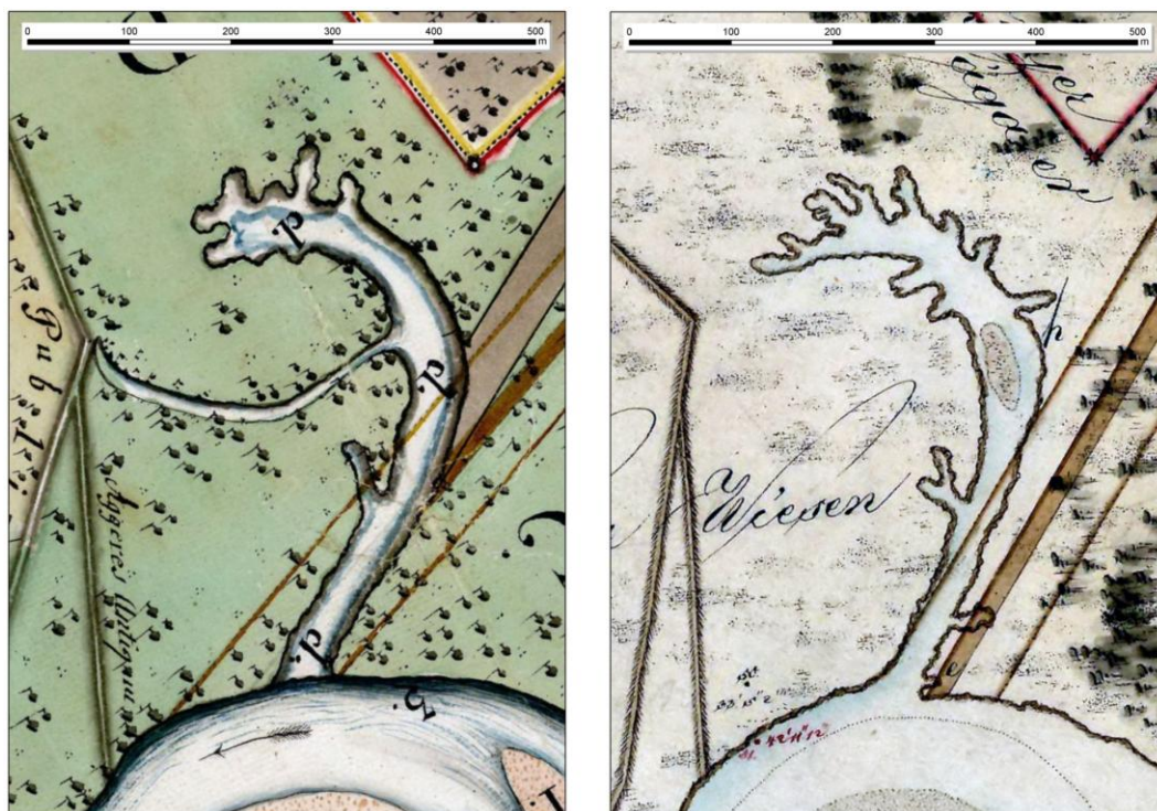
Obr. 4 Prievalové koryto a jazero, vymleté pri katastrofálnej povodni v auguste 1813. Zákres na pláne J. Vizera z novembra 1813 (vľavo) a na pláne J. Glatza z apríla 1815 (vpravo).
