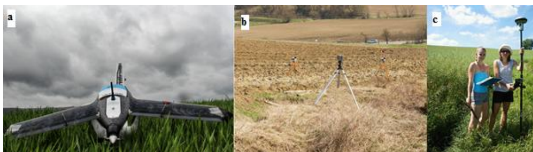
Obr. 5 Použité zariadenia na zber priestorových dát a) UAV, b) TLS, c) GNSS
