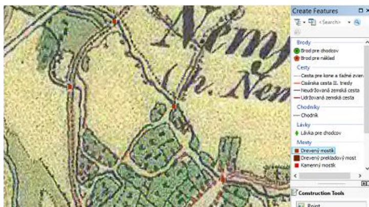
Obr. 12 Vektorizované bodové objekty Drevený mostík
