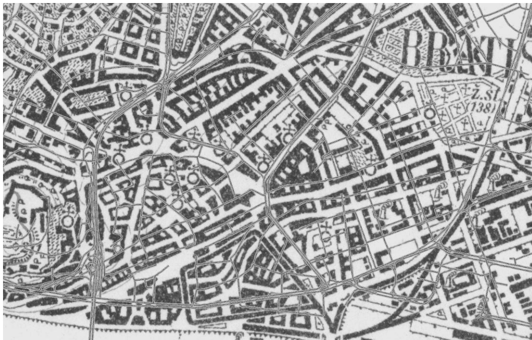
Obr. 3 Prekryt topografickej sekcie III. VM a rastrovej vrstvy ZBGIS (aktuálny stav). Transformácia realizovaná využitím rohov topografických sekcií
