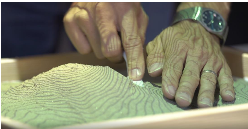
Obr. 2 Interakcia s fyzickým modelom z kinetického piesku pričom sa v reálnom čase premietajú vrstevnice a farby reprezentujúce výšku modelu
