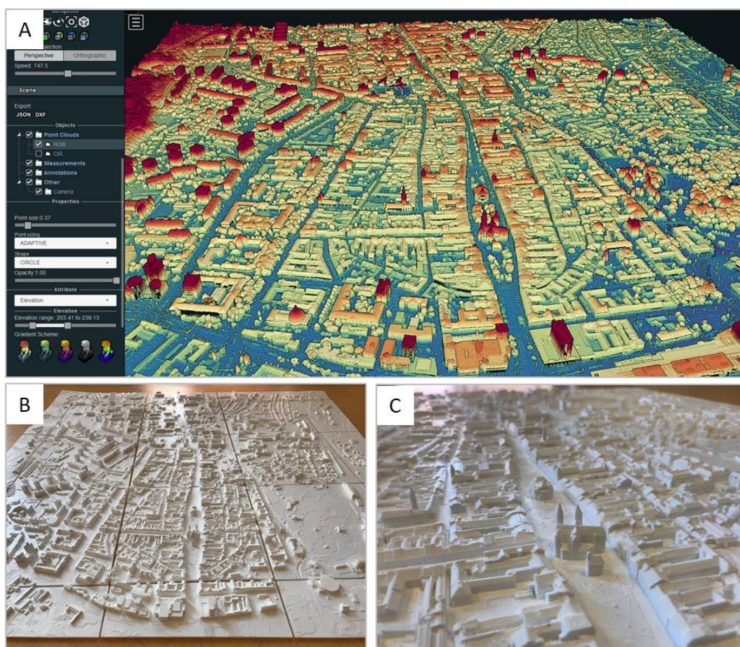
Obr. 3 Mračno bodov získané laserovým skenovaním a fotogrametriou zafarbené podľa nadmorskej výšky (A) a z neho odvodený plastový 3D model centra Košíc v mierke 1 : 2400 v podobe dlaždíc (19×19 cm) (B) a v priblížení na okolie Dómu sv. Alžbety (C).
