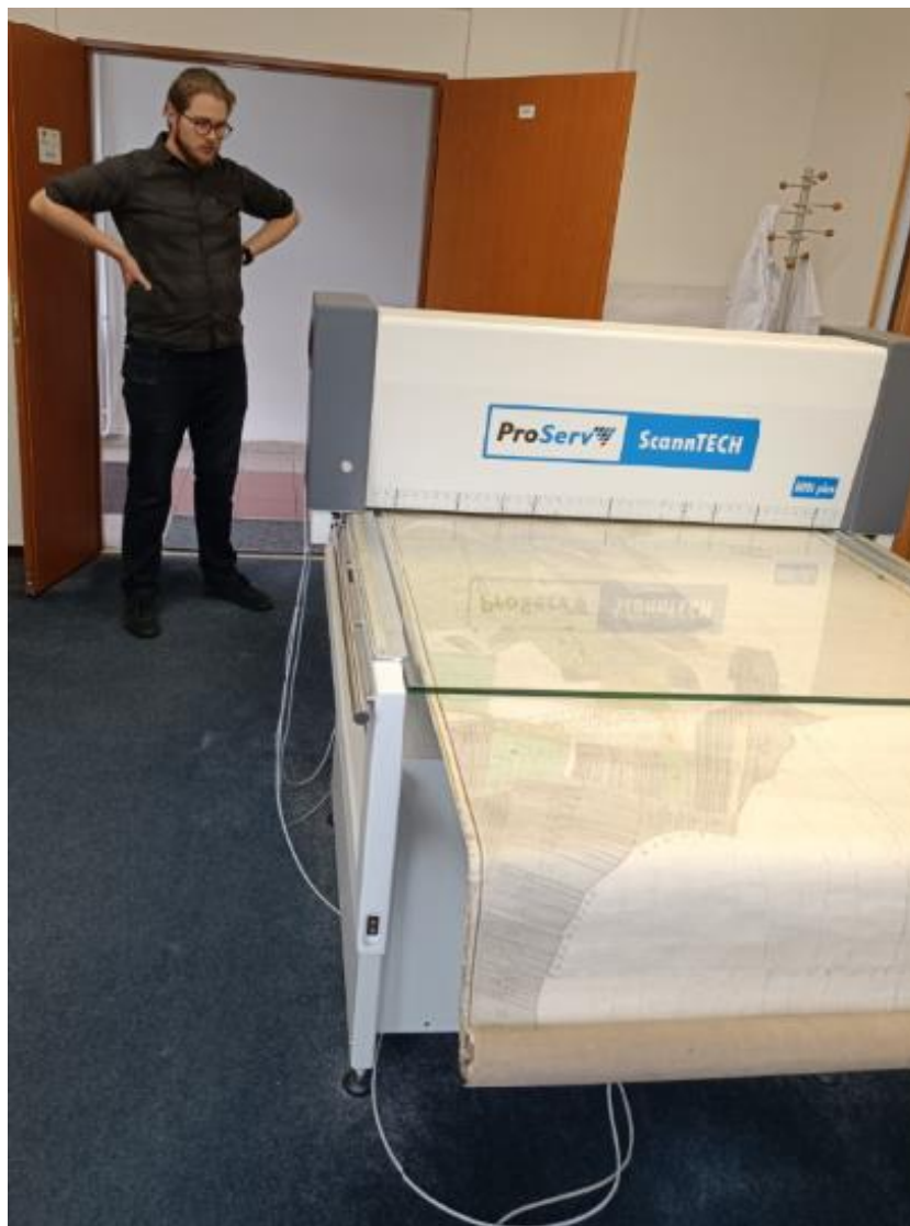
Obr. 8 Skenování rukopisné mapy rozměrů 900 × 3 200 mm na velkoformátovém skeneru VÚGTK (foto autoři článku)
